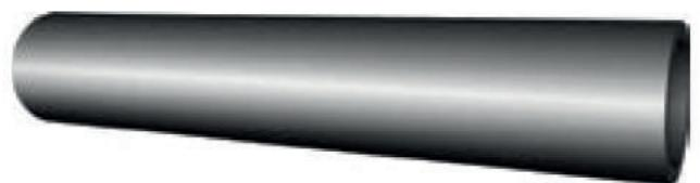
Эластичный шланг, устойчивый к заломам, для установки на автомобильное оборудование. Используется для топлива из нефти с ароматическими углеводородами до 50% в составе, биоэтанола с кислородными соединениями до 15% и биодизельного топлива (80% д/т, 20% биокомпонентов — эфиров).
